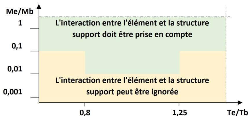
*Proposition de l'AFPS sur la nécessité ou non de prise en compte de l'interaction dynamique entre élément non structural/équipement et la structure (Recommandations AFPS90, 1993).*
