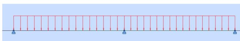
A mi-travée 1, on obtient  $|V|_{\max} = 31.3 \text{ kN}$  :
