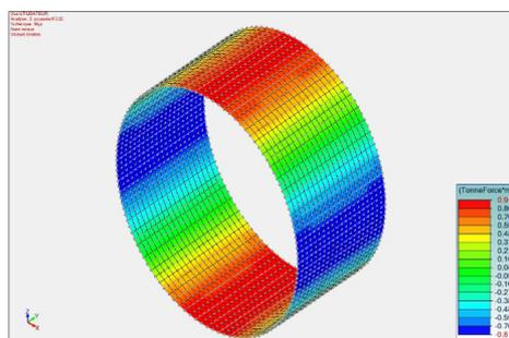
La charge introduite sur la barre, est définie comme une charge horizontale au mètre linéaire mesuré perpendiculairement à l'action de la charge (une verticale dans le cas présent).
