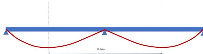
Une étude fine serait à réaliser pour trouver la position précise des camions, mais on se rend immédiatement compte (ici pour des travées de 25 m - rappel) que les camions doivent être séparés pour obtenir un effet maximal :
