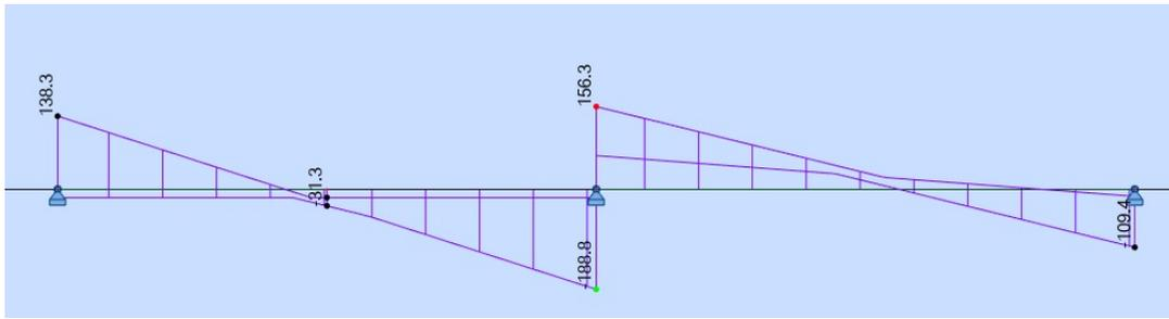
Le diagramme ci-après montre le même diagramme de tranchant, mais avec une poutre chargée suivant les LI :
