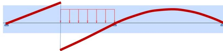
On obtient  $|V|_{\max} = 53.7 \text{ kN}$ , soit un écart relatif conséquent.
